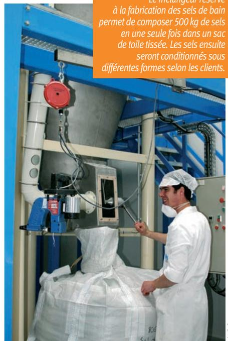
Le mélangeur réservé à la fabrication des sels de bain permet de composer 500 kg de sels en une seule fois dans un sac de toile tissée. Les sels ensuite seront conditionnés sous différentes formes selon les clients.
