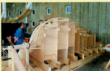
Coque retournée en cours de serrage.
