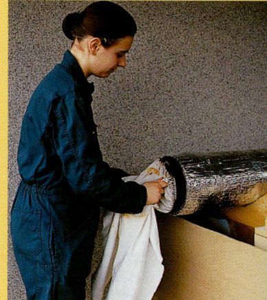
Émilie Éraud sortant de l'étuve les arrondis du bord d'attaque des ailes (becs de perroquet).
