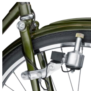
Figure 3 Eclairage alternateur d'un vélo
