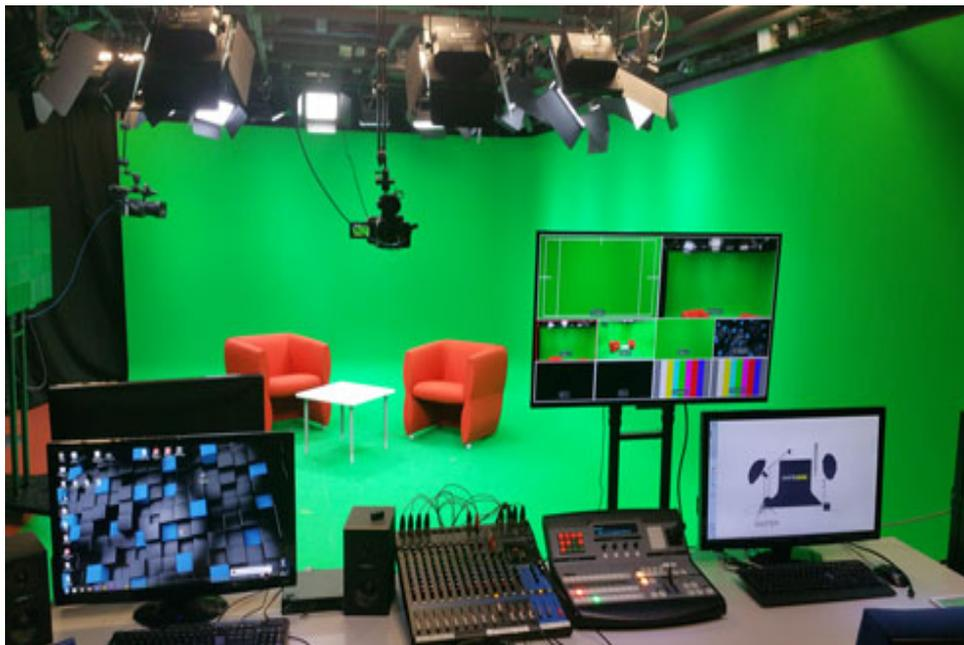
Un cyclo vert (moquette verte) pour l'incrustation vidéo a été installé, ses dimensions sont 25 m<sup>2</sup> au sol, la hauteur est de 2.50 m.
