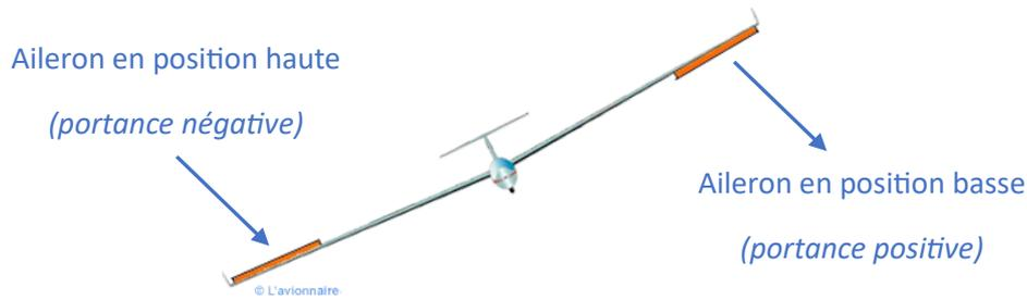
Pour cela il suffit d'appliquer une force de torsion sur toute la longueur de l'aile (appelé gauchissement) afin d'obtenir deux angles d'attaque différents, et ainsi deux portances différentes.
