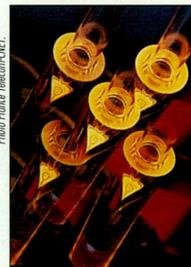
Les fibres optiques sont obtenues par étirement à chaud d'une préforme en verre. Multipliant par 100 les débits des réseaux de télécommunications, les fibres optiques sont "le bitume" des autoroutes de l'information.
