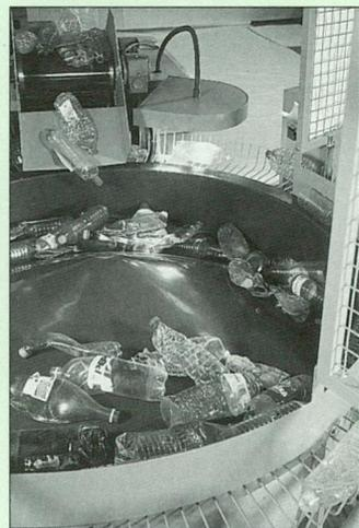
▲ Mis au point avec l'IRMA et l'IFP (Institut français du pétrole), Dibop est une machine à trier les bouteilles en plastique.
