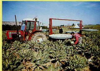
Montée sur vérins hydrauliques, la nouvelle remorque se place au niveau des cueilleurs pour une meilleure ergonomie.
