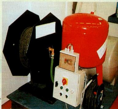
▲ Le "Bugs Farm" fonctionne comme un incubateur biologique : aisément transportable dans une fourgonnette, il est utilisé pour traiter les colonnes d'eaux usées des immeubles.
