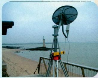
Avant de réaliser les essais sur les îles du Morbihan, des tests de distance (30 km) ont été effectués entre la pointe Saint-Gildas et la pointe du Croisic en Loire-Atlantique, plus faciles d'accès.
