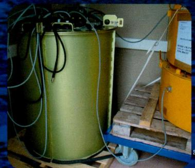
Caisson contenant l'électronique à l'intérieur des bouées ancrées.
