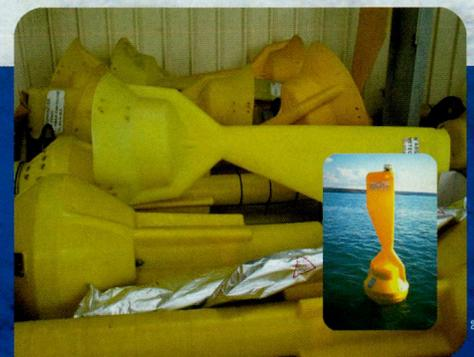
Bouées dérivantes de type Marisonde GT qui permettent de mesurer la pression atmosphérique, la température de l'air, la vitesse et la direction du vent ainsi que la température de la mer.
