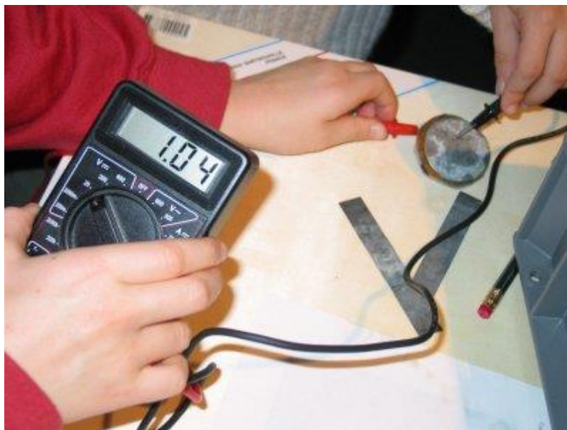
Tension aux bornes de la pile
