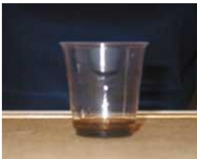
*Dans un gobelet en plastique, mélanger deux solutions (l'un contient un diisocyanate, l'autre contient un polyol, un agent d'expansion et un catalyseur)*
