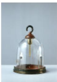
Cet instrument, construit vers 1850, reproduit exactement un type d'électroscope du XVIIIème siècle. Deux pendules très légers terminés par des balles de sureau sont suspendus à une électrode en crochet, à l'intérieur d'une cloche de verre. En chargeant l'électrode, les pendules divergeaient. Les bandelettes d'étain placées sur la clochette évitaient que les charges s'accumulent sur le verre.
