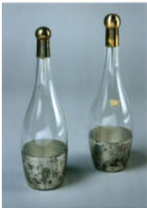
Dans ces deux vases recouverts en partie d'une armature extérieure en feuille d'étain, et avec un bouchon en laiton muni d'une soupape, il était possible de faire le vide à l'aide d'une pompe pneumatique. La décharge d'une machine électrique produisait à l'intérieur de ces matras des lueurs électriques simulant les effets d'une aurore boréale d'où le nom anglais de « aurora flasks ».
