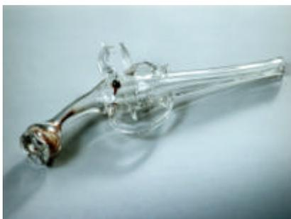
Ce récipient en verre, reproduisant la forme d'un pistolet, est traversé par une électrode. Le pistolet était rempli d'un mélange détonnant d'oxygène et d'hydrogène ou même de méthane et d'air. En approchant l'électrode du conducteur d'une machine électrique ou d'une bouteille de Leyde, on provoquait une étincelle dans le pistolet. Le mélange explosait en projetant le bouchon qui fermait la bouche.
