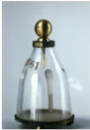
Cet appareil est un bocal de verre, reposant sur un plateau en laiton, et dont le goulot est fermé par un bouchon recouvert d'un vernis à la gomme laque, ainsi que toute la partie supérieure du bocal. Dans le bouchon passe une tige de laiton terminée à l'extérieur par une boule, de même métal, et à l'intérieur par deux feuilles d'or battu très légères.
