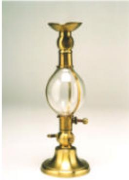
L'eudiomètre de Volta est un instrument qui permettait de mesurer la quantité d'oxygène contenu dans l'air.
