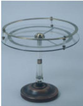
Un disque de verre sur lequel est collé un anneau en feuille d'étain, que l'on pouvait relier à la terre, porte une couronne circulaire métallique. Le disque est fixé à une colonne isolante. Quand la couronne était en communication avec une machine électrique, une boule légère de verre soufflé (manquante) posée sur le disque tournait sur elle-même et le long de la couronne. Le double mouvement était provoqué par les phénomènes de répulsion et d'attraction électrostatique.
