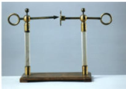
Cet appareil est formé de 2 électrodes portées par des colonnes isolantes en verre. Les électrodes étant reliées aux 2 bornes d'une bouteille de Leyde, il était possible de faire éclater une étincelle entre la pointe et le disque. Cette étincelle permettait d'étudier les effets mécaniques produits par le passage de l'électricité. Par exemple, on faisait passer la décharge à travers un morceau de bois bien sec pour le voir voler en éclat.
