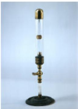
Ce tube en verre est muni de deux électrodes de laiton, l'une en forme de pointe et l'autre en forme de boule. L'air était évacué du tube par une machine pneumatique qui se vissait sur le robinet en laiton. On reliait alors les électrodes à une bouteille de Leyde pour observer les modifications de la lueur électrique selon la pression de l'air (elle était pourpre dans le vide) ou la nature du gaz (elle était rouge dans l'hydrogène, verte dans la vapeur de mercure...).
