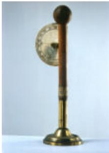
Cet appareil, proposé par William Henley en 1770, est constitué d'une légère tige mobile (manquante) pivotant au centre du cadran et pouvant tourner sous l'action répulsive d'une charge électrique. Cet instrument, peu précis, était utilisé pour estimer la quantité d'électricité accumulée par une bouteille de Leyde ou fournie par une machine électrique. Pendant la charge de la machine, l'aiguille divergeait jusqu'au moment où la tension maximale était atteinte.
