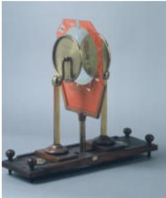
Un condensateur est un appareil qui permet d'accumuler des quantités considérables d'électricité sur de petites surfaces. Il en existe plusieurs types, tous se composant de deux corps conducteurs séparés par un isolant : c'est le cas de la bouteille de Leyde.
