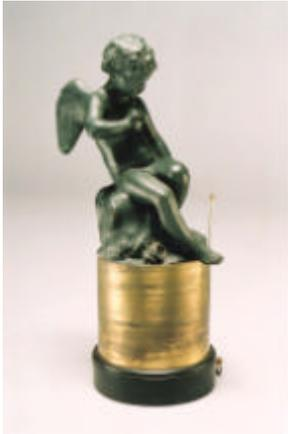
Cet objet était plus une curiosité de salon qu'un véritable instrument scientifique. Il s'agit d'une bouteille de Leyde dont l'armature extérieure est composée d'un cylindre de laiton tandis que l'armature intérieure est cachée par une statuette décorative qui surmonte l'appareil.
