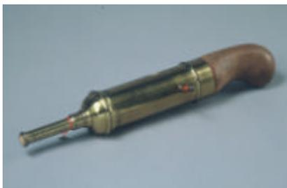
Ce petit canon en laiton avec un manche en bois reproduit approximativement la forme d'un pistolet. Le mélange de gaz détonnant dont il était rempli s'enflammait grâce à une étincelle électrique. L'explosion des gaz projetait le bouchon qui fermait la bouche du pistolet et du canon.
