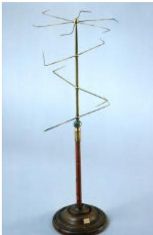
Ce tourniquet est mobile sur un petit pivot métallique, isolé du sol, que l'on faisait communiquer avec une source continue d'électricité, par exemple au moyen d'une chaîne métallique.
