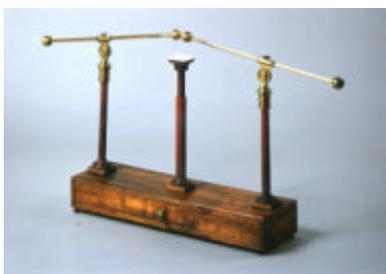
Pour faire passer facilement la décharge d'une batterie au travers des corps solides, on employait ordinairement l'excitateur universel. L'excitateur est formé de 2 tiges métalliques, portées par des colonnes isolantes, et pouvant s'incliner et glisser dans leurs montures.
