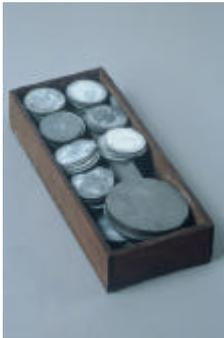
Volta semble avoir inventé un appareil pouvant agir indéfiniment, sans besoin de recharge comme une bouteille de Leyde ou de frottements comme dans la machine électrique.
