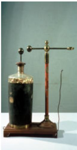
Elle consiste en une bouteille de Leyde dont l'armature intérieure est mise en communication par un cordon métallique avec une source électrique dont on veut connaître le débit.
