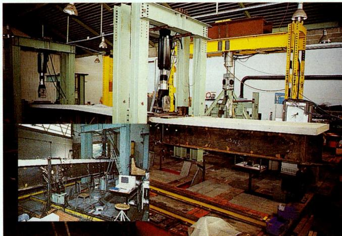
▲ Poutre mixte continue de 15 mètres, à 2 travées, expérimentée pour simuler le comportement de poutres de ponts à différents états limites.
