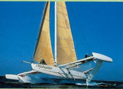
bateau rêvé et testé depuis de nombreuses années par Éric Tabarly et Alain Thébault. Le principe de l'hydroptère est simple : faire sortir les coques de l'eau grâce à une poussée verticale réalisée par des plans porteurs immergés - les foils (ailerons). Dans sa version actuelle, ce trimaran est capable de s'élever à 4 m au-dessus des flots lorsqu'il atteint la
