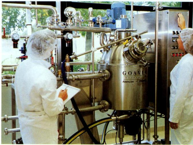
◀ Dans sa cuve de 60 litres, le "Robostar" permet de tester une large palette de process : plusieurs types de cuisson, pasteurisation, refroidissement, travail en surpression et sous vide, trois types d'agitation.
