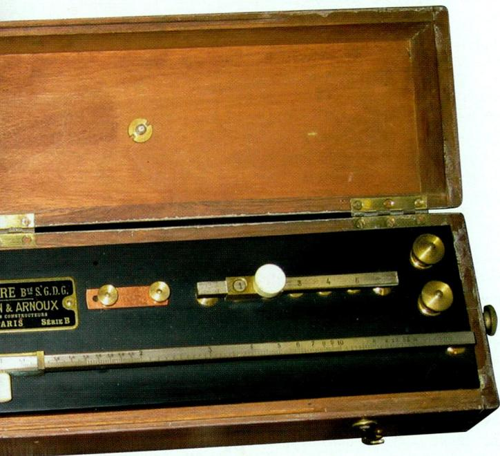
L'un des premiers ohmmètres (vers 1880), reposant sur le principe du "Pont de Wheatstone".
