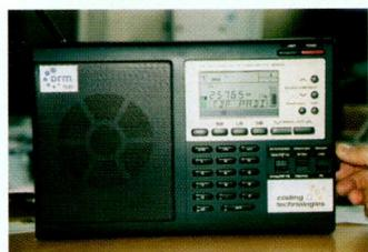
Les récepteurs ne sont pas encore commercialisés. Celui-ci, d'une marque allemande, n'a que quelques mois et coûte 1000 €. Il n'a pas de composants intégrés spécifiques à la DRM : c'est un micro-ordinateur déguisé en récepteur radio. Les premiers transistors d'un nouveau type devraient voir le jour en 2005. Un marché qui pourrait être juteux pour les constructeurs.
