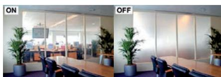
Certains vitrages contiennent un film de cristaux liquides placé entre deux feuilles de verre. Une tension électrique établie entre ces deux feuilles aligne les molécules : le vitrage est transparent (ON). Lorsque la tension cesse (OFF), les molécules se désorientent et diffusent la lumière dans toutes les directions : le vitrage est translucide.
