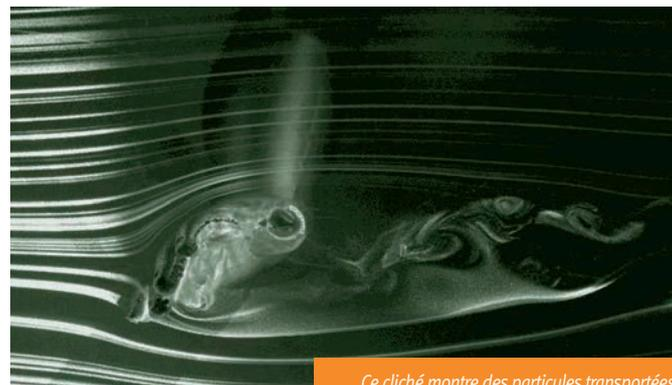
Ce cliché montre des particules transportées par un écoulement autour d'une main. L'écoulement amont est laminaire (lignes parallèles sur la gauche de la photo) et il devient turbulent dans le sillage de la main (à droite).
