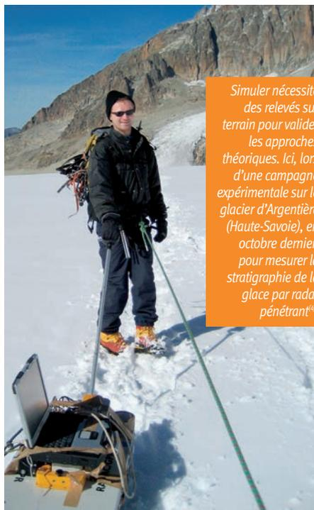
*Simuler nécessite des relevés sur terrain pour valider les approches théoriques. Ici, lors d'une campagne expérimentale sur le glacier d'Argentière (Haute-Savoie), en octobre dernier, pour mesurer la stratigraphie de la glace par radar pénétrant<sup>(4)</sup>.*
