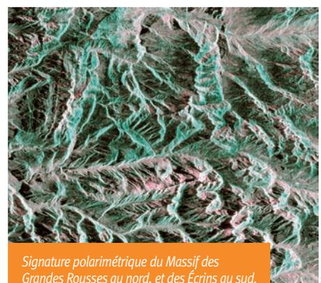
*Signature polarimétrique du Massif des Grandes Rousses au nord, et des Écrins au sud. En rouge, le canal VV, en vert, le canal VV-HV et en bleu le canal HV. Ces données, acquises le 8 avril 2004, proviennent du capteur Asar embarqué sur le satellite européen Envisat.*
