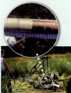
Un carottier, ici sorti et posé sur un châssis, est un instrument qui est utilisé par les palynologues pour prélever des cylindres de sol, des carottes. Ici, la carotte en gros plan, graduée en centimètres, est distinctement composée de tourbe marron foncé et de vase grise.
