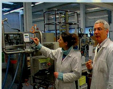
Patrick Bourseau et Séverine Cros (thésarde de l'équipe) en train de travailler sur un pilote préindustriel, permettant de traiter des volumes de solution relativement importants (50 l), et ainsi d'extrapoler les résultats obtenus au laboratoire sur des pilotes de plus petite taille.
