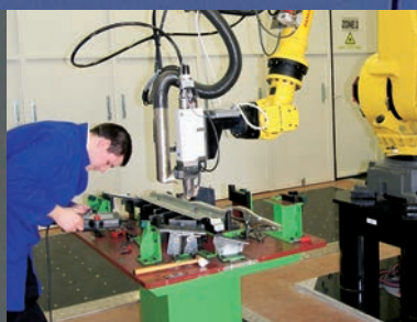
La soudure laser des carrosseries en test.
